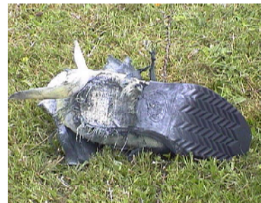
La Bota de Combate BfR después de una explosión de 70g en el talón
