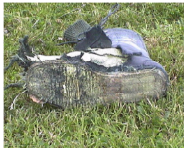
La Bota de Combate BfR después de una explosión de 50g en el antepié
